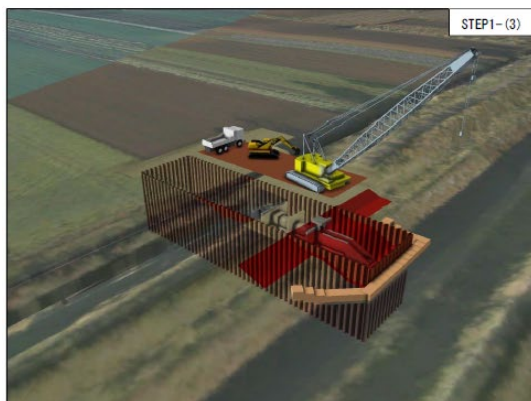
図 3-16 施工計画において活用する BIM/CIM モデルの例（1）
