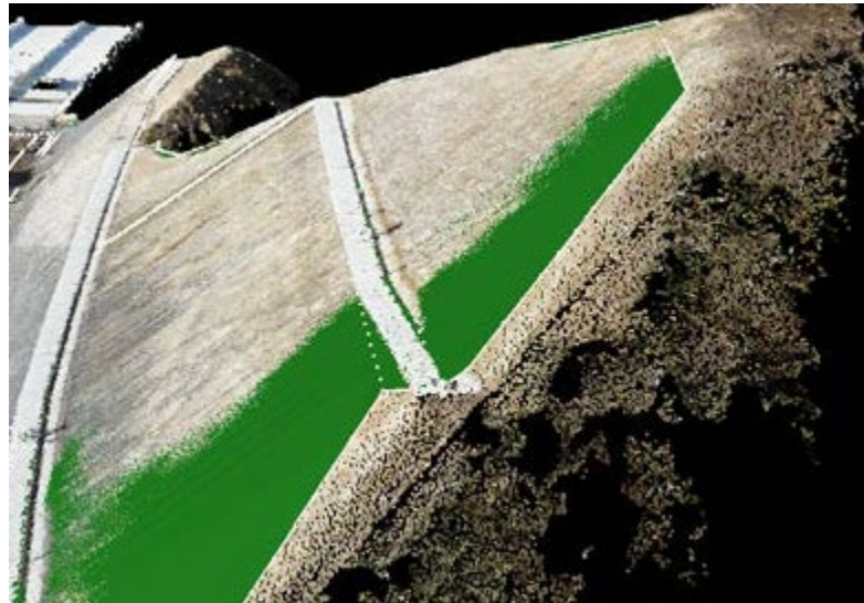
3次元測量から得られた点群データモデル
