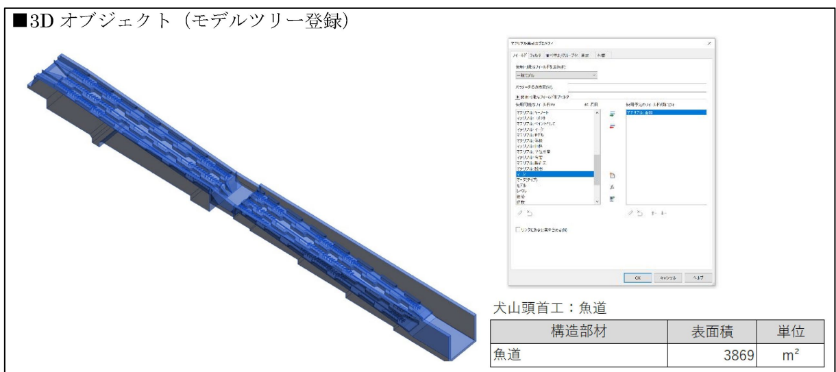
図 3-20 数量計算において活用する BIM/CIM モデルの例（2）
