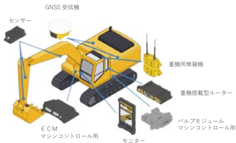
図5-11 ICTバックホウの機器構成例
