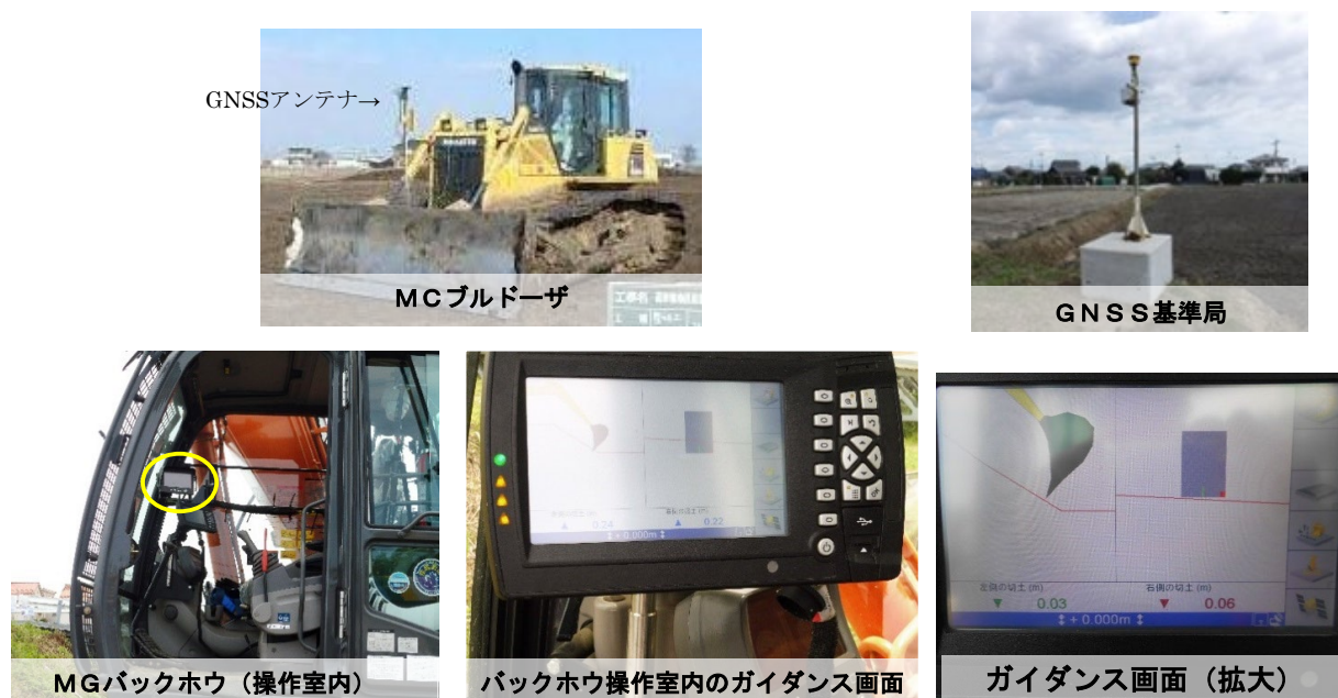
図3 ICT建設機械の構成イメージ
