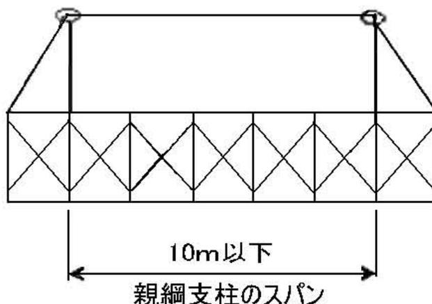
イ 親綱支柱を設置した作業床と衝突のおそれのある床面等との垂直距離（H）に応じて使用することのできる親綱支柱のスペン（L）は、次式により算出した値以下であること。ただし、Hは3.8 m以上を確保すること。
