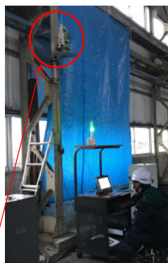
稼働中の既設排水機場の沈下量を自動計測（写真2）
