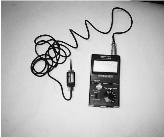
図 4. 8-17 振動計の外観例
