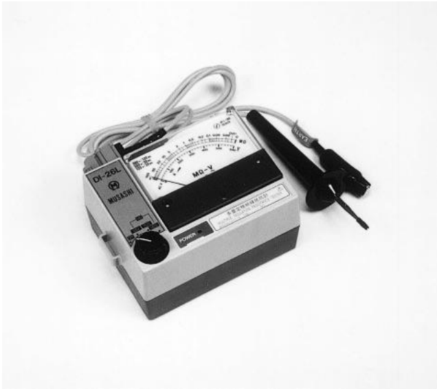
図 4. 8-6 絶縁抵抗計の外観例
