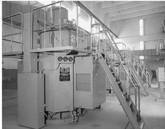
図 3.1-2 立軸保護防滴自由通流形巻線形電動機の外観例
