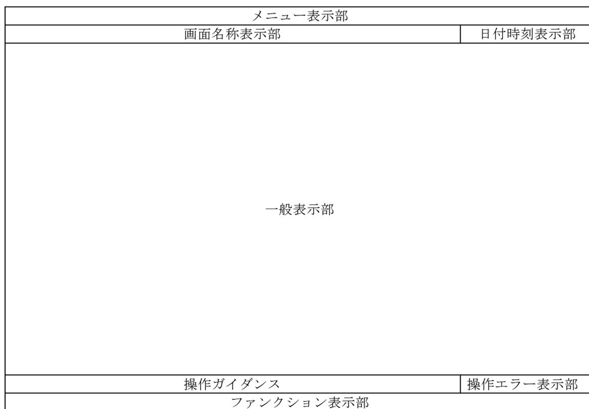
図 3.2-20 ディスプレイ表示基本レイアウト（例）
