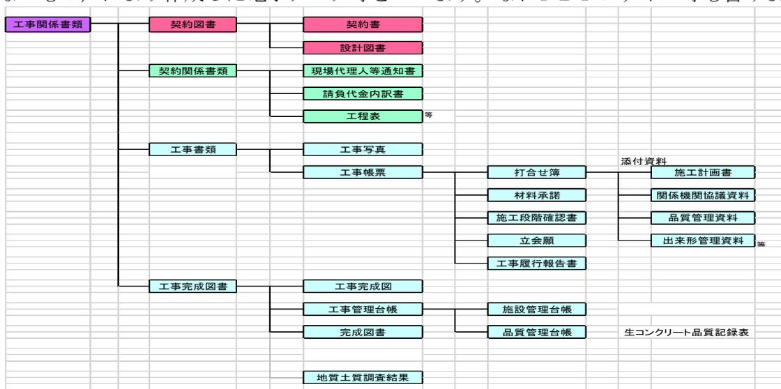
図 1-2 電気通信設備工事における工事関係書類の体系図
