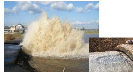
管水路における漏水事故 PC管の劣化
