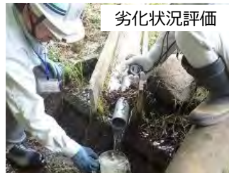
堤体からの漏水量計測
