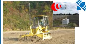
衛星測位による機械制御
