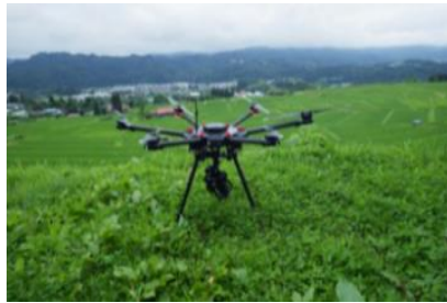
ドローンによる3D測量
