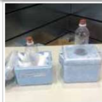
ペットボトルで作った 「人工雪発生装置」を使った実験
