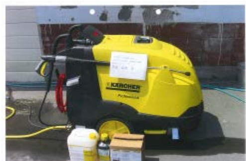
【設置した洗車機】
