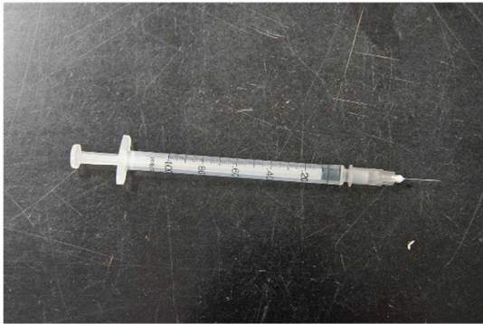
1ml シリンジに 27G(0.41mm 径)の平針を装着
