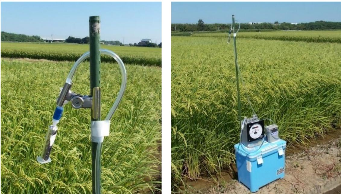
図 14 散布確認調査における気中濃度調査(左：捕集カラム、右：設置状況)
