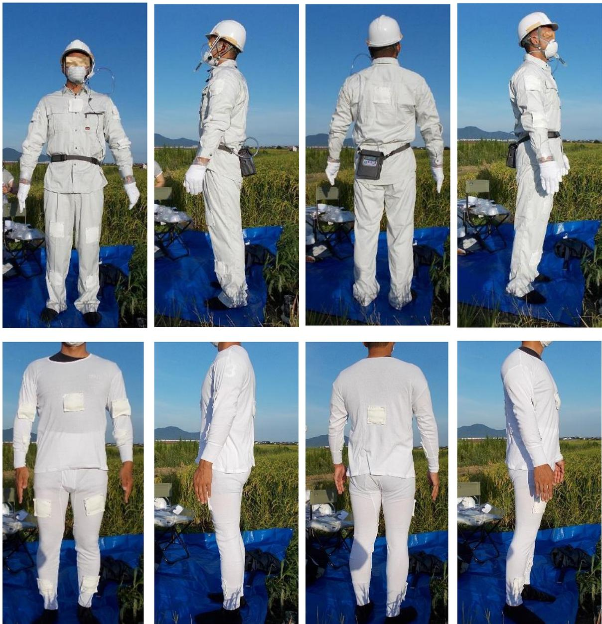
図8 操縦者・補助者の身体表面暴露量調査 調査装備
