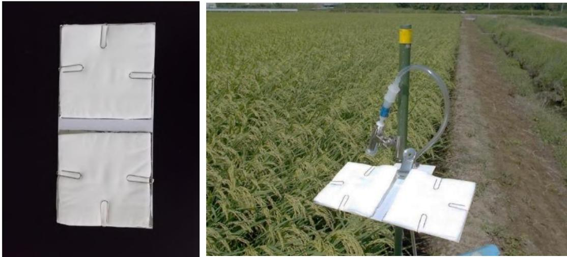
図 13 散布確認調査における付着量調査(左：調査用ガーゼパッチ、右：設置状況)
