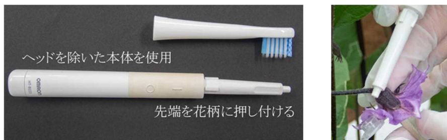
図1. 採取に使用した電動歯ブラシと花粉採取の様子
