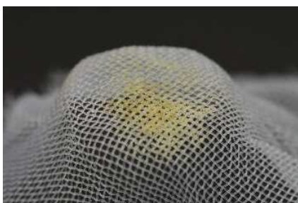
降雨日の外部フィルタ
