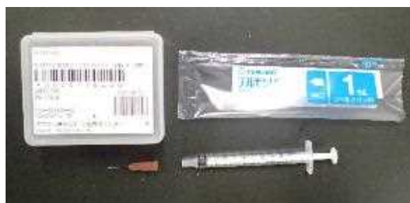
図 18. 注射器と注射針（内径 0.20mm, 針長 13mm）
