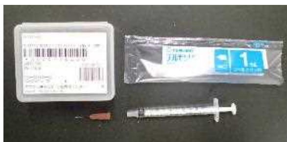
図 18. 注射器と注射針（内径 0.20mm, 針長 13mm）
