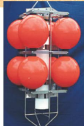
サケのエサとなる海中のプランクトンを測定する「プランクトンモニタリング用多周波ソナー」
