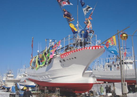
省エネ・省コストに優れた第二十八板丸。安全性・居住性も向上しており、甲板での作業を操舵室からモニタリングできるカメラが設置されたほか、居住区にはエアコンも装備
