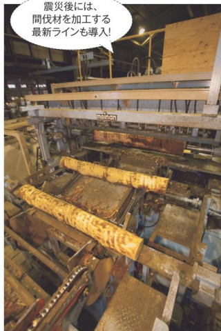
国産材用に震災後新しく導入した機械。丸太をダイコンのかつらひきのように薄くスライスする
