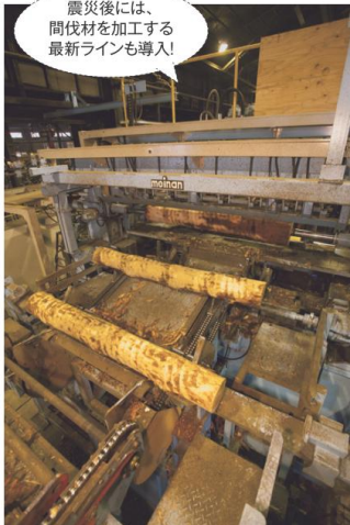
国産材用に震災後新しく導入した機械。丸太をダイコンのかつらつきのように薄くスライスする
