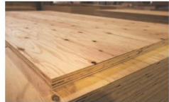
住宅建築で耐力壁や床板の下地として使われる構造用合板。厚さ24mm。国産材は節があるのが特徴
