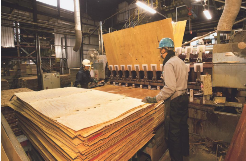
接着剤を塗って乾燥させた薄板を重ね合わせる。その後、9枚ずつ加熱しながら圧着し、左右を規格どりに裁ち落として合板が完成
