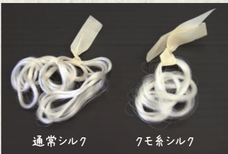
左は通常シルクの生糸、右はクモ糸シルクの生糸。これまで、遺伝子組み換えカイコは実験用の品種で作っていたため、組み換え繭糸を生糸にすることが困難だった。今回、生糸を作ることができる品種のカイコを使って遺伝子組み換えを行うことで、クモ糸のタンパク質を含む組み換え生糸を作ることに成功した
