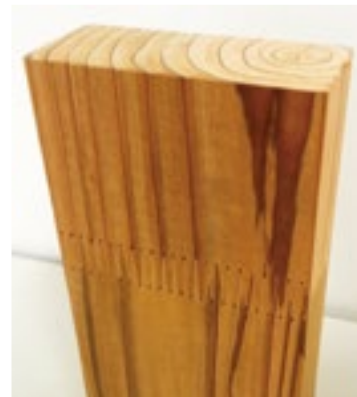
木材の先端をギザギザに加工し、接着剤で長手方向につなぎ合わせるフィンガージョイント加工。
