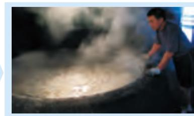
ろ過した塩水を16時間鍋で本焚きし、煮つめて塩を結晶させる
