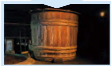
濃い塩水を荒焚きし、竹炭・黒炭・砂が層になった桶でろ過する
