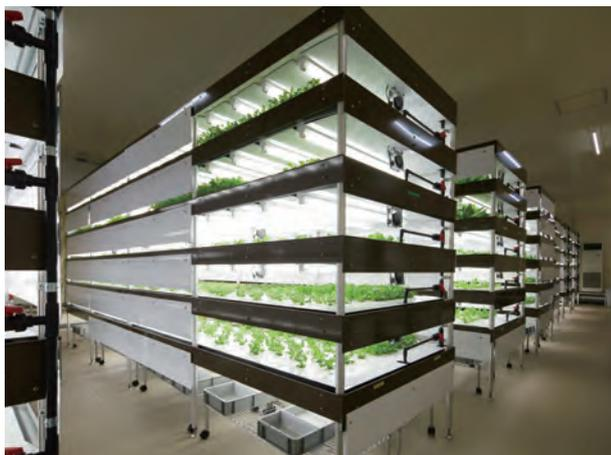
LEDを利用した人工光型植物工場の栽培室。
