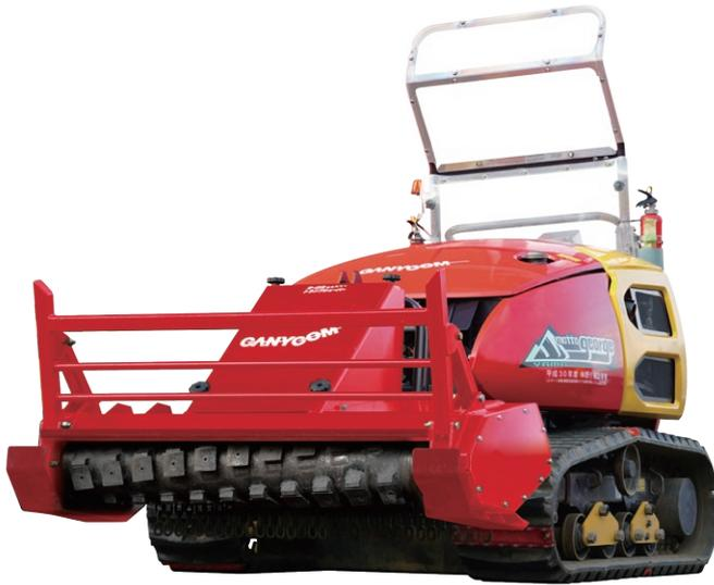
機械化の進んでいない造林作業の省力化や効率化を目的に開発された多目的造林機械「山もっとジョージ」。アタッチメントの付け替えによって、一台で植栽前の整地や植栽後の刈り払いができ、前後左右30度までの傾斜地に対応可能。遠隔操作化、植え穴掘り用のアタッチメント開発も進めています。
