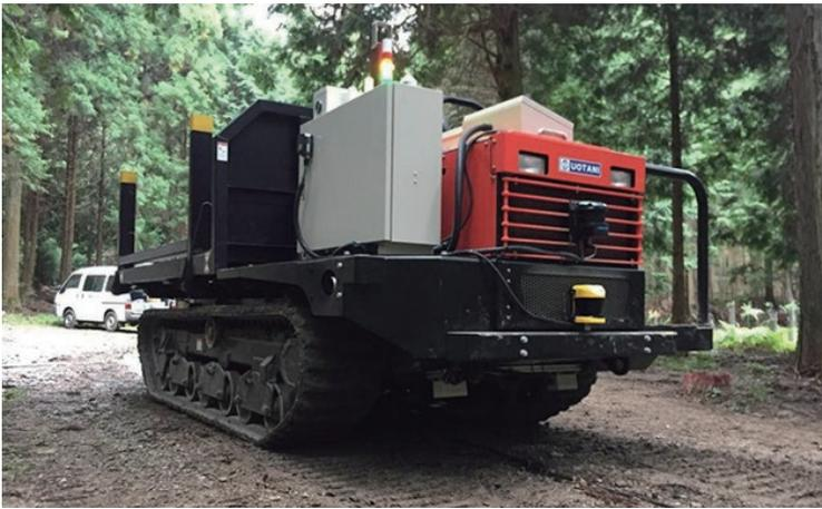
「自動走行フォワーダ」は、森林作業道上の誘導電線を検知して自動走行をさせることで、伐採現場から目的地までの木材運搬を自動化。走行可能な総延長距離は約1キロメートルで、有人運転時と同じ速度で走行できます。
