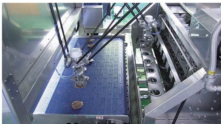
世界初のホタテ貝自動生剥き機の「オートシェラー」。ホタテ原貝を投入するだけで自動的に、殻・ミミ・ウロ・貝柱を分離させて貝柱だけを生のまま回収。11人分の処理能力を持っています。
