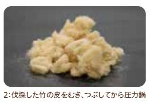
2:伐採した竹の皮をむき、ぶつしてから圧力鍋で煮て竹綿を製造します。
