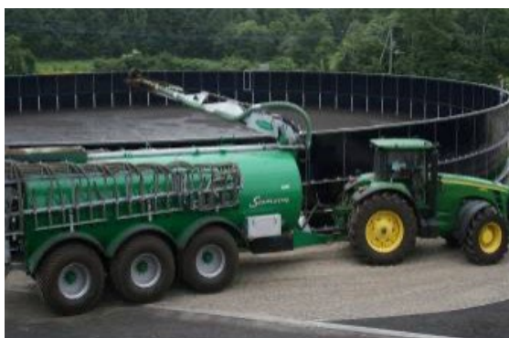
消化液を貯留槽から散布車両へ。
