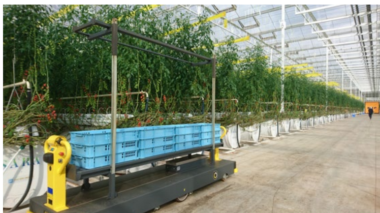
収穫された野菜をパッキングエリアまで運ぶ自動運搬台車。
