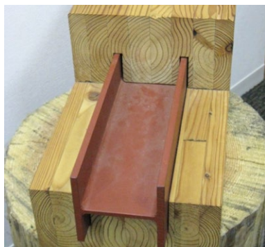
集成材被覆鉄骨 断面 (mm) : 240×240
