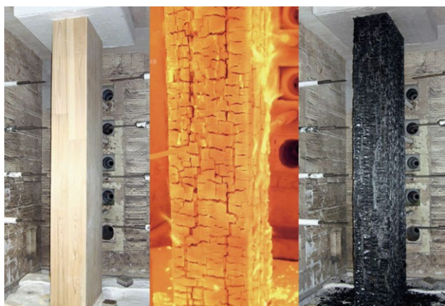
FRウッド®の加熱試験の様子。左から、加熱試験前、加熱試験中、加熱試験後。
