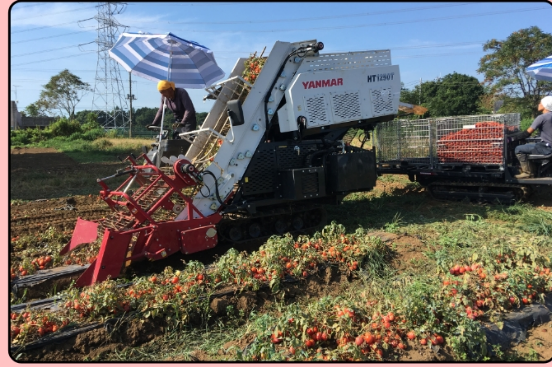
ヤンマーと共同開発した加工用トマト専用の収穫機 「Kagome Tomato Harvester KTH」
