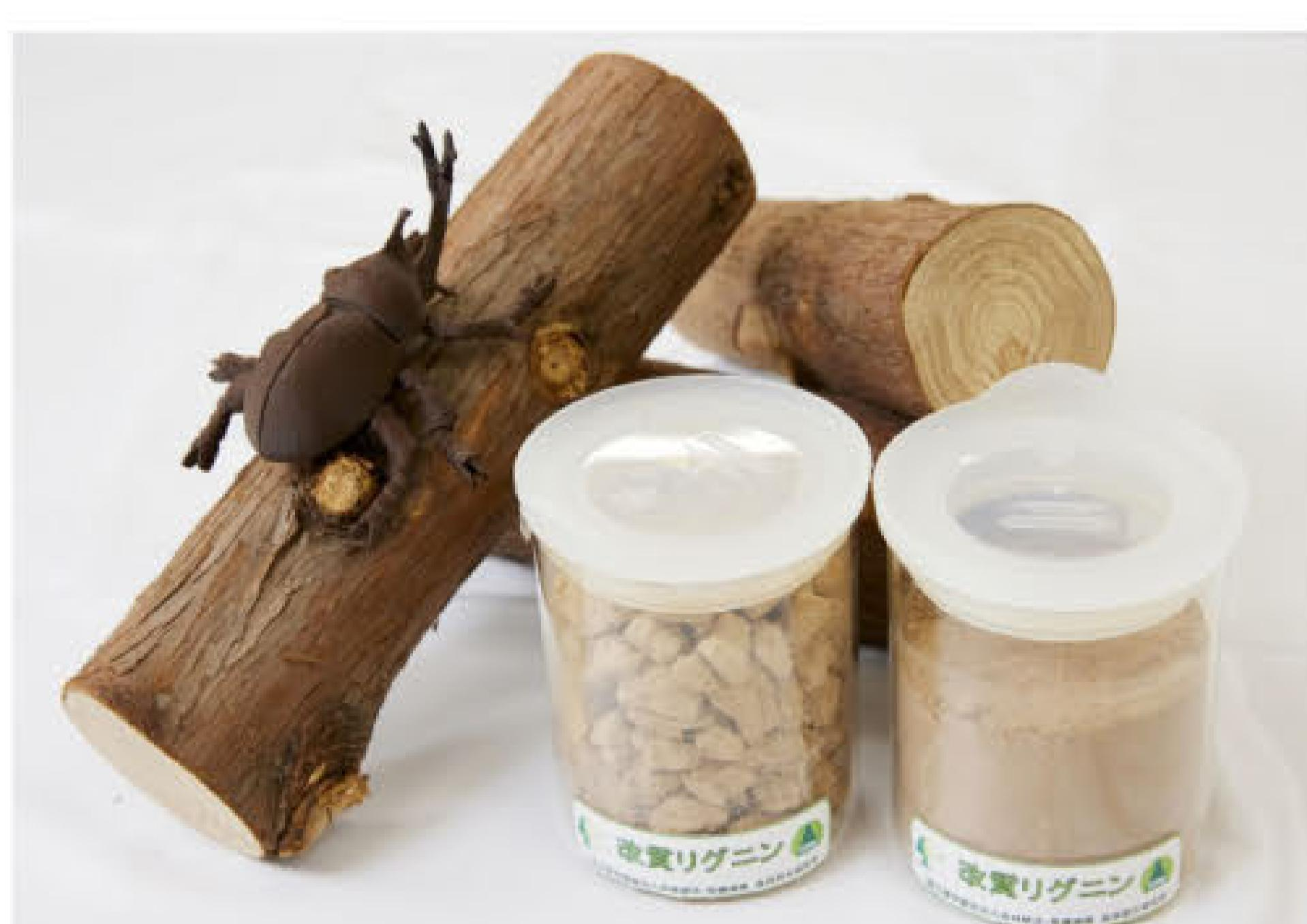
スギの原木と改質リグニン。なお、スギにつかまるカブトムシは、3Dプリンター用生分解性改質リグニンフィラメントを材料に、3Dプリンターで造形したもの。精巧でとても軽量です。
