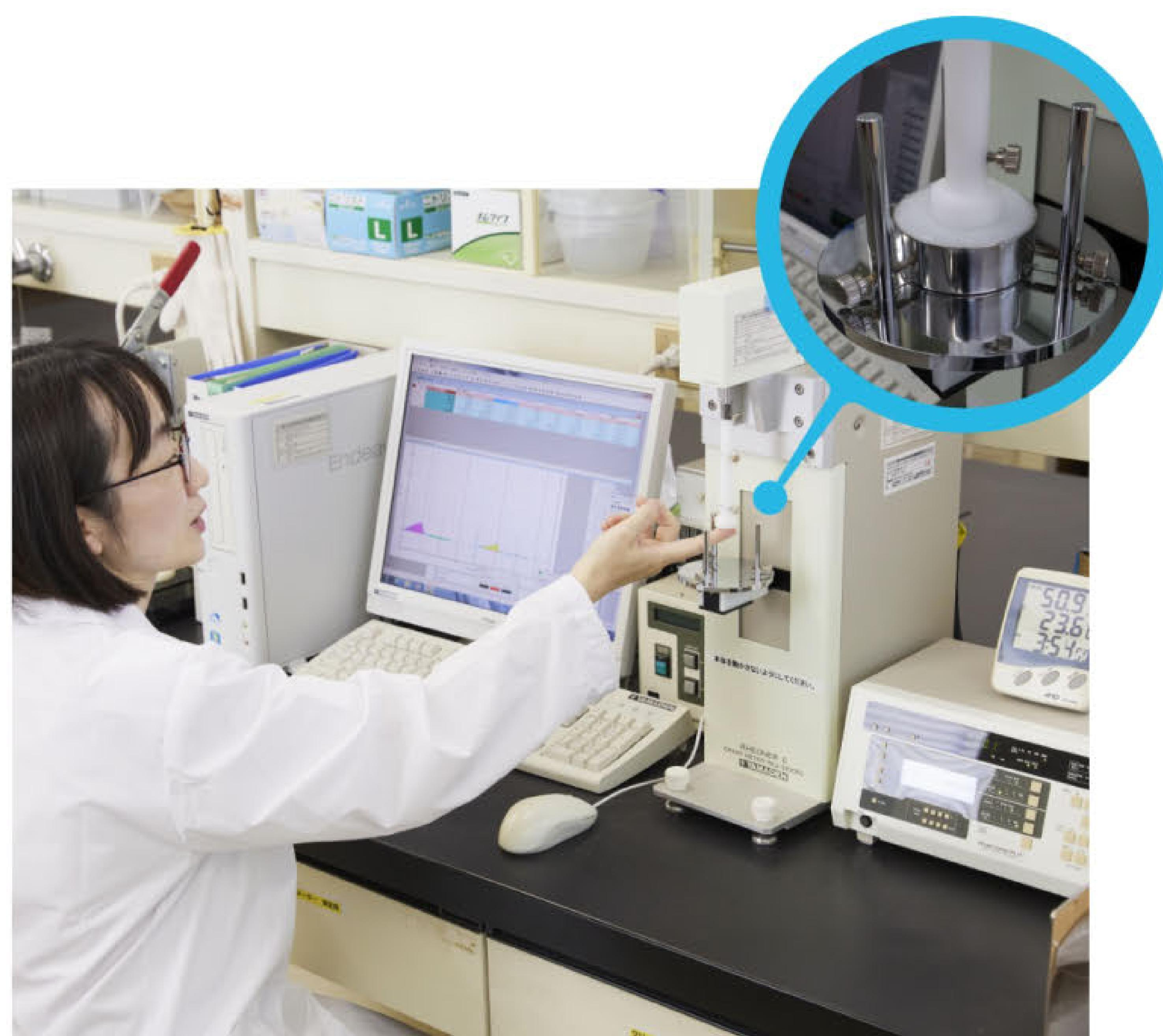
専用の測定器でさまざまな米粉用品種から作る米粉ゼリーの物性を繰り返し試験。同じアミロースでも品種により性質が異なるため、それぞれの性質を把握し精査してブレンド率を決めていきます。
