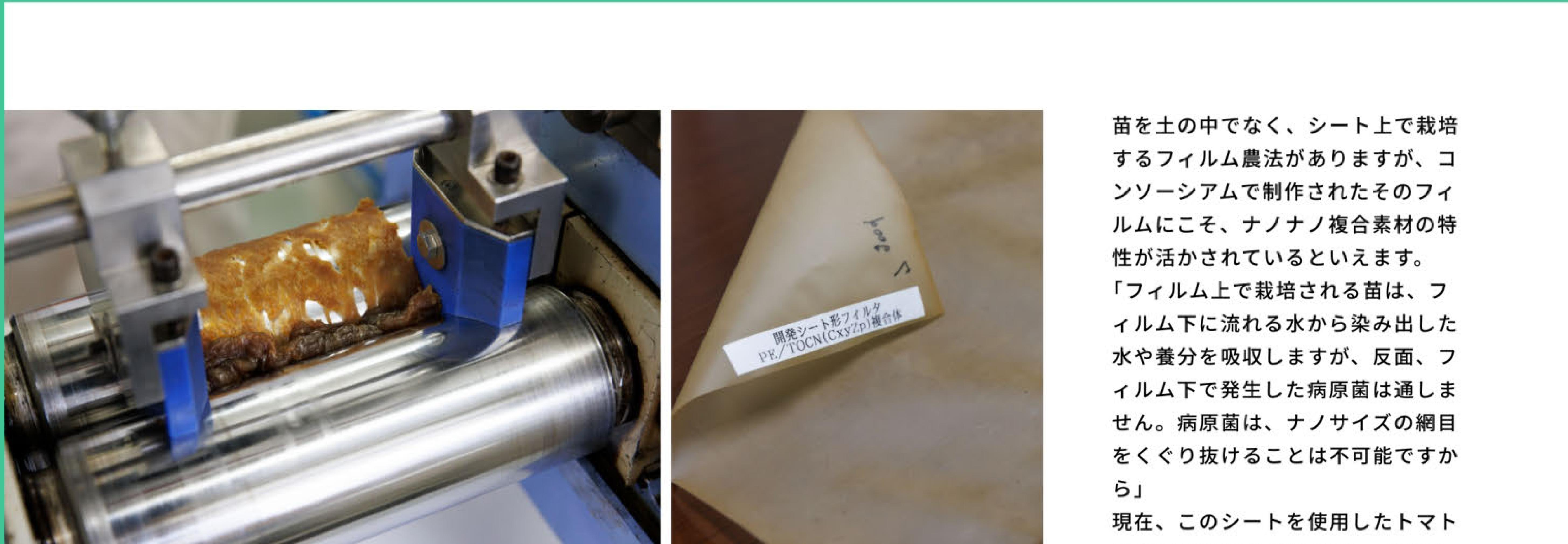
左：混練機によりCNFと廃プラスチック剤などを混ぜ合わせ、高性能なナノナノ複合材料を作り出します。右：天然ゴムにCNFを混練したシート型フィルタ。ナノサイズの網目構造で水分は通す一方、病原菌は通しません。
