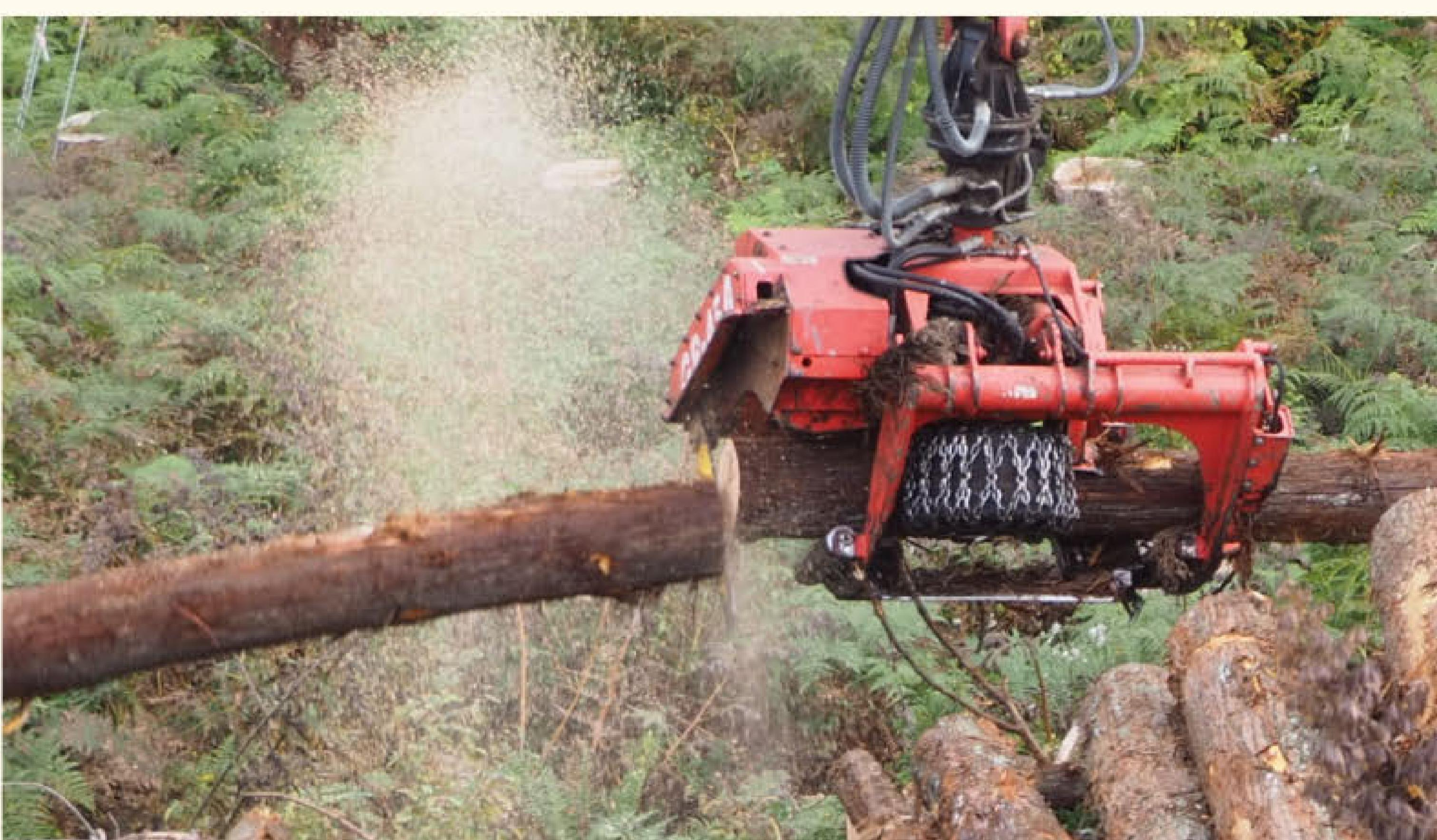
次に寸法の自動計測と玉切りを連続して行います。玉切りとは必要とされる長さに丸太を切り分ける作業。つかんだ丸太を、内蔵されたチェーンソーでスパッと切断します。コンピューターで制御されているので、センチメートル単位の精度で長さを切り揃えられます。プロセッサの周囲には、みるみるうちに切断された丸太が積み上がっていきました。
