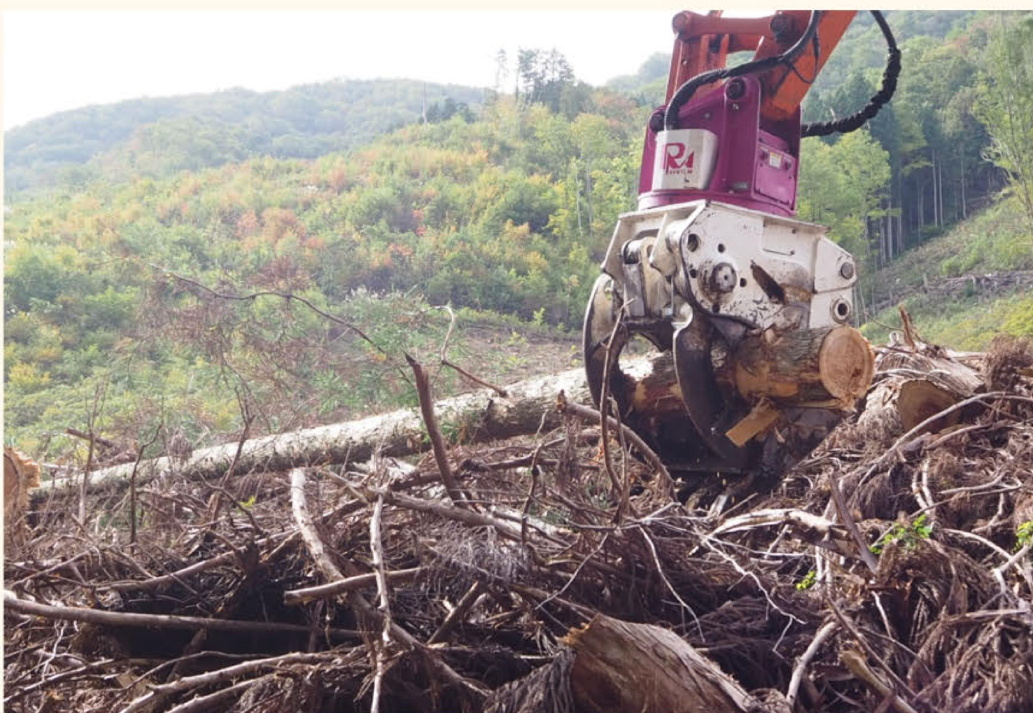
伐倒された立木は、バケット部分に格納された刃物が瞬時に切断。メリメリバキバキと大きな音を立てて、木が倒れます。1本の伐倒にかかる時間は、ほんの10秒ほど！続いて強力なグリップ力のアタッチメントが、倒木をぐいとつかんで造材する場所まで寄せます。高性能林業機械の圧倒的なパワーには目を見張るばかりです。
