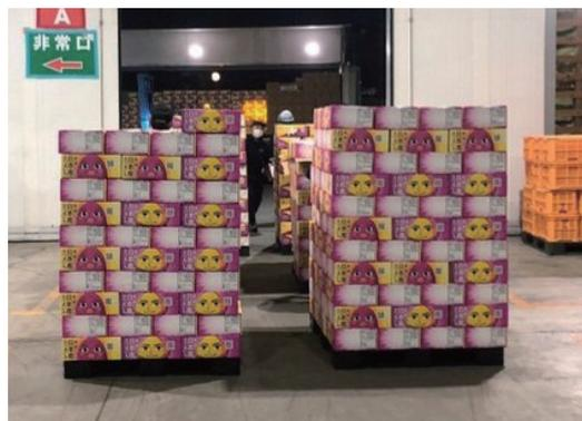
40フィートのコンテナに12配のパレットを隙間なく詰められるサイズにすることで輸送コストを低減させた。
