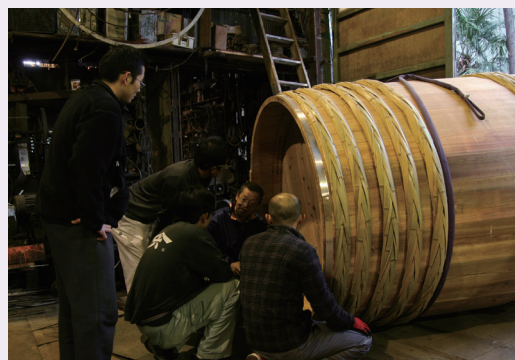
竹を編み上げた「竹たが」を入れ、最後に底板を打ち込んだら完成。竹は小豆島のものを使用している。
