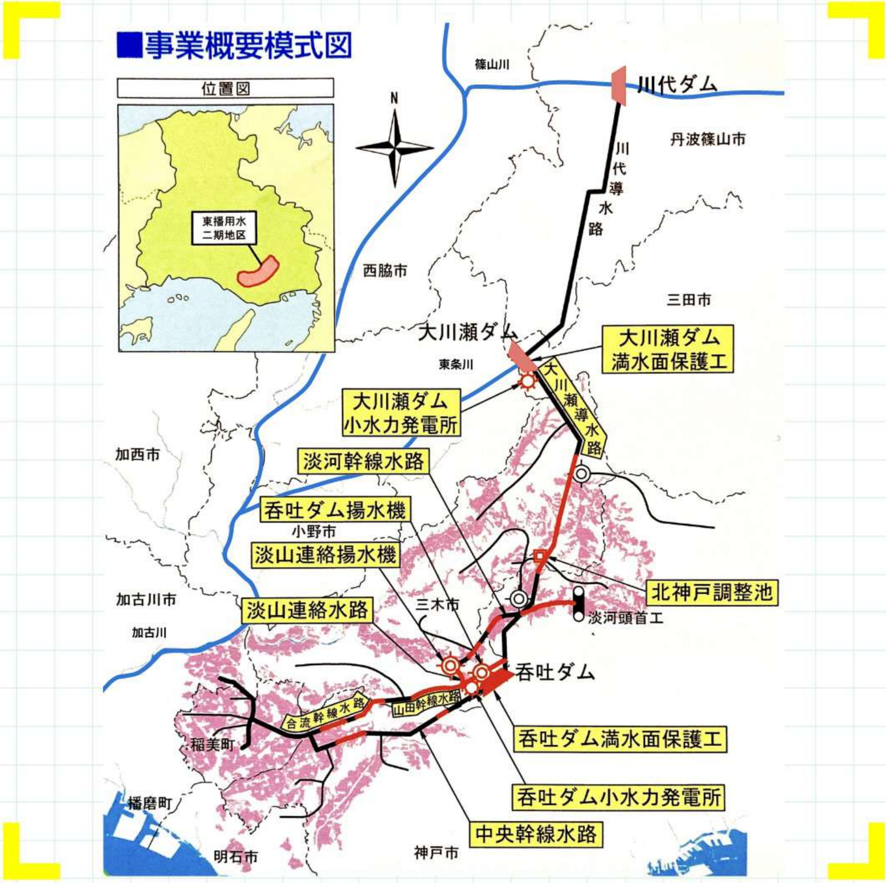
東播用水二期事業の概要模式図。3つのダムを結ぶ幹線水路を中心に、水利ネットワークが張り巡らされていることがわかります。
