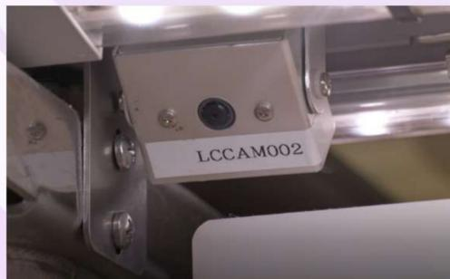
寿司が流れるレーンの上部に設置された小型カメラの画像分析により、どのテーブルで何枚のお皿を取ったかを、自動でカウント。
