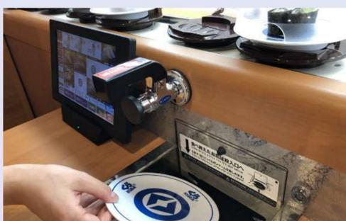
テーブルの皿回収ポケットに寿司皿を投入すると、水流により皿が洗い場まで運ばれます。
