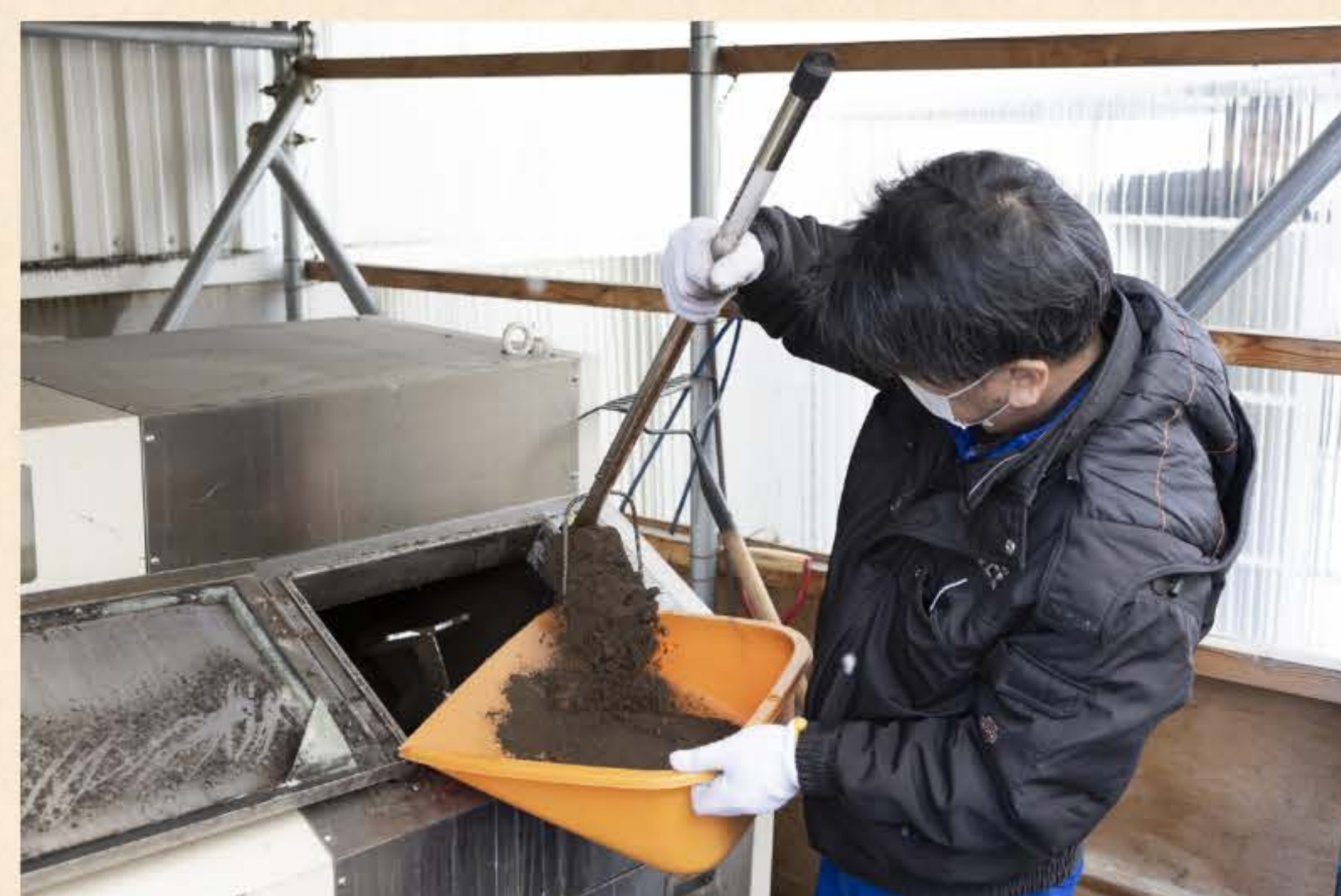
本社敷地内に設置した生ごみ処理機で食品残さを堆肥化。
