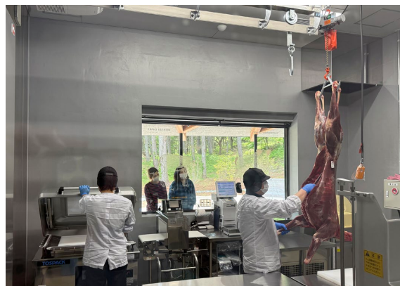
洗浄・剥皮・解体後、加工室でロース、モモ、スネなどの部位ごとに切り分け、真空パック詰めに。骨や腿、余った肉などはペット用に仕分けられます。加工処理室はガラス張り、外からも見学可能です。 写真提供＝富士山ジビエセンター DEAR DEER
