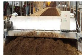
基礎なしロータリー式攪拌機
