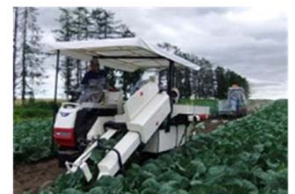
キャベツの収穫機(機械化) 【農業新技術2013選定 ：平成26年度より販売開始】
