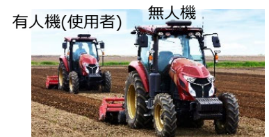
ほ場内からの監視による自動走行
