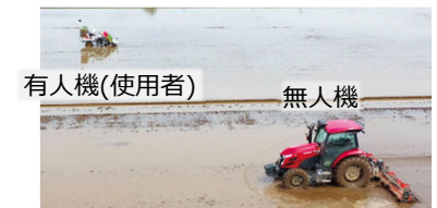
隣接ほ場からの監視による自動走行
