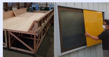
従業員による作業場改善 (疲れにくい高さにした自作の調製作業台 及びはめ込み式の雨戸)
