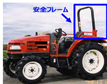
トラクターへの安全フレーム等の装備
