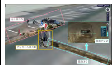
下水道管路内と地上部のデータを 重ね合わせた3Dモデル
