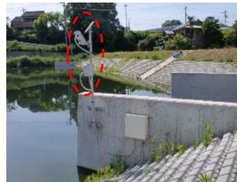
防災重点農業用ため池の遠隔監視機器の設置
