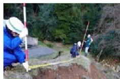
被災ため池の法面崩落の状況調査
