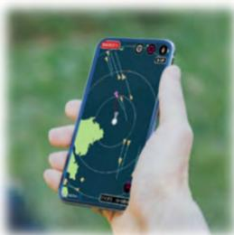
AISと同様の機能を有するスマートフォン向けアプリケーションが、リリースされています。スマートフォンアプリは、AIS機器の導入が難しい小型漁船(船外機船等)でも利用可能！
